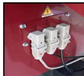
Inserire i cappucci ciechi sulle prese del lato libero per evitare contatti accidentali con le prese di corrente rimaste vuote. Aprire il portellone centrale CARICAMENTO LEGNA, controllare che le barre della griglia per la LEGNA siano al loro posto negli appositi incastri.
